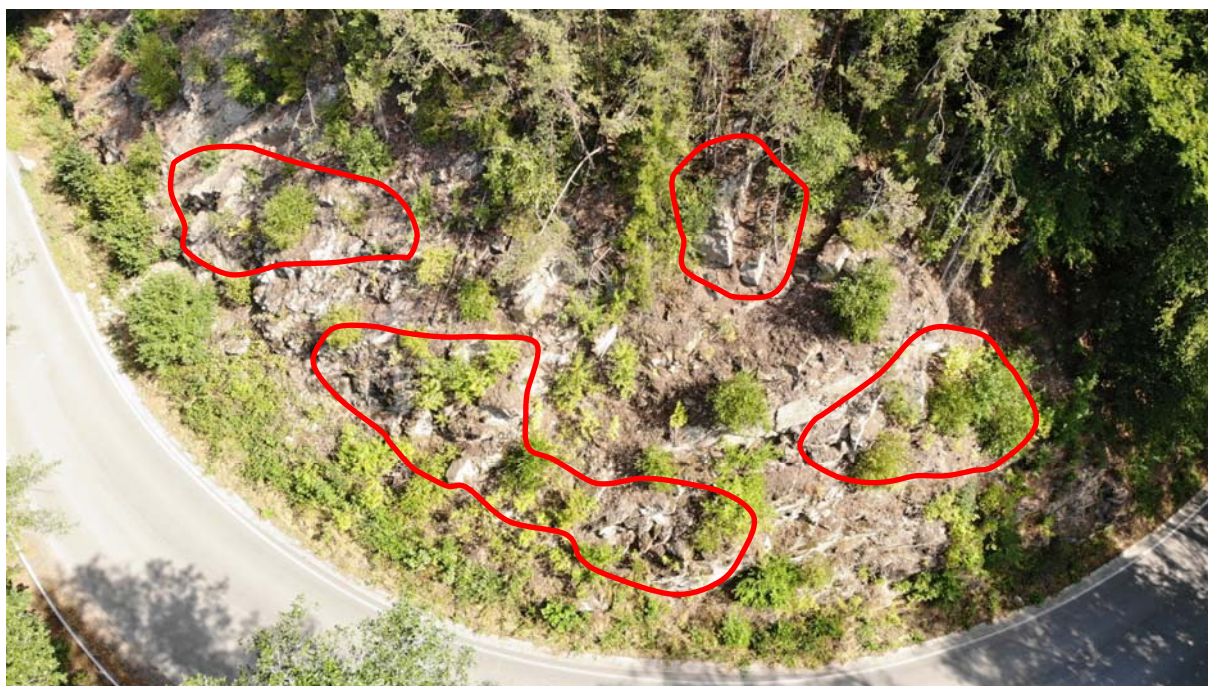
Obrázek 12: horní pohled na skalní masiv v hlavním rozsahu s vyznačením ploch výrazného narušení stability masivu
