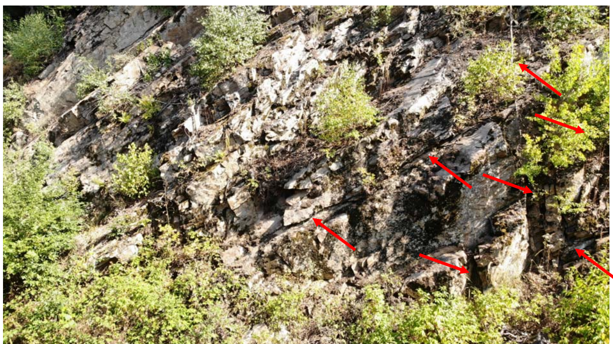
Obrázek 6: detail narušení masivu, šipky vyznačují pukliny – plochu diskontinuit v rozevření více jak 25 mm!! V těchto plochách je znatelný erozní toký vody ze srážek a
